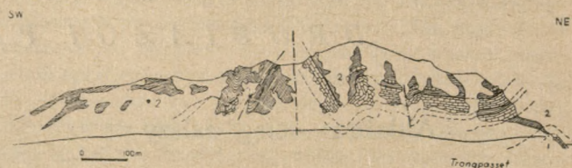
Ryc. 3. Szkic perspektywny obrazujący budowę geologiczną SE zbocza Góry Skłodowskiej-Curie (wg autora, 1958 r.). 1 — łupki i piaskowce dolnotriasowe; 2 — łupki i margliste mułowce („wapienie”) środkowo-górnego triasu. Dyslokacje nieciągłe oznaczono linią kreska-kropka
