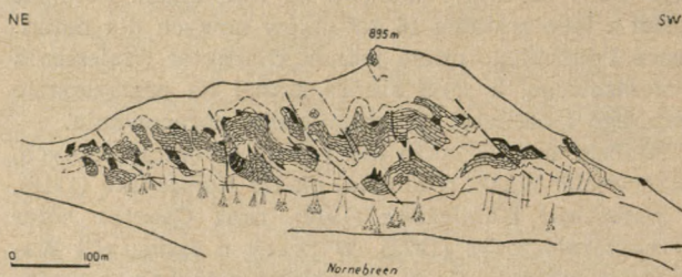
Ryc. 2. Szkic perspektywny obrazujący budowę geologiczną NW zbocza Góry Skłodowskiej-Curie (wg autora, 1958 r.). Widoczne silnie sfałdowane łupki (oznaczone barwą czarną) i margliste mułowce („wapienie”) środkowego i górnego triasu, ponasuwane na siebie w postaci łusek tektonicznych wzdłuż płaszczyzn dyslokacyjnych (oznaczonych linią kreska-kropka)
