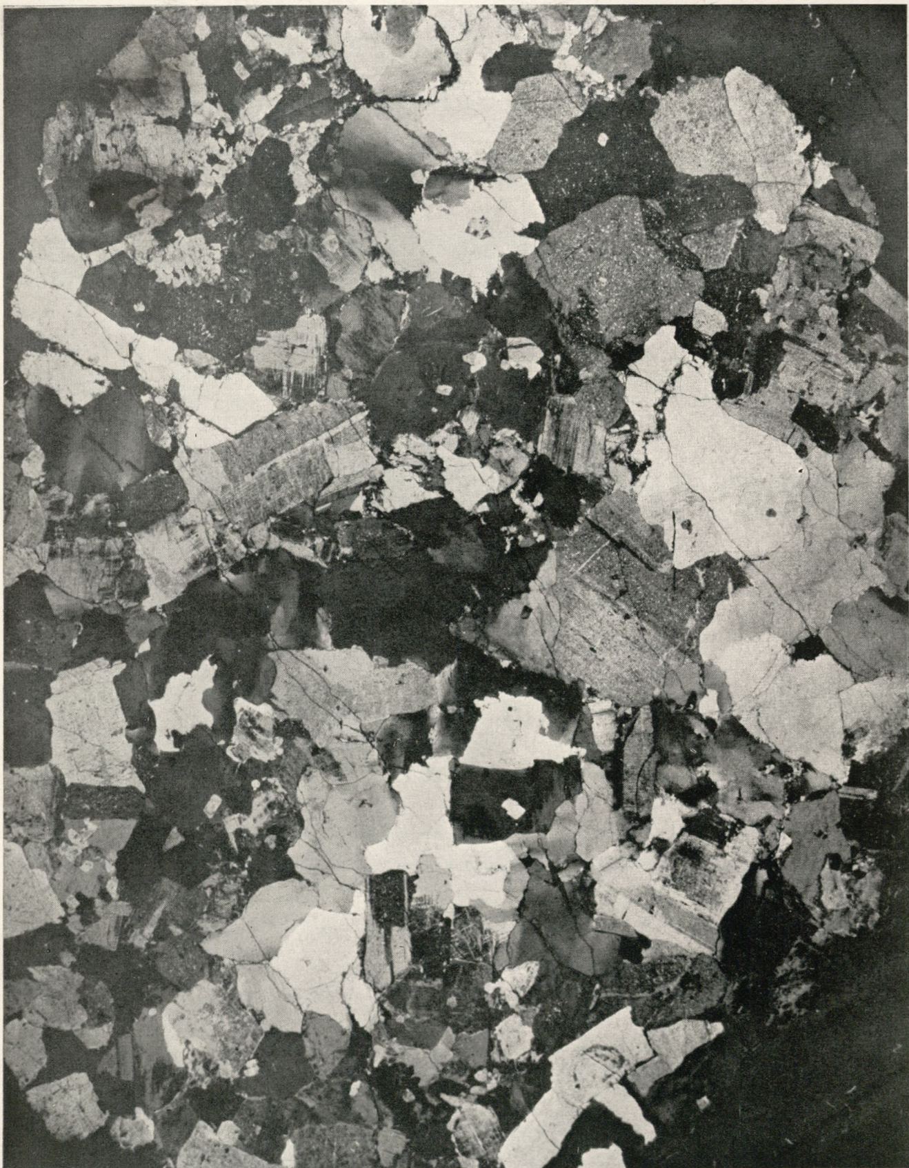
IV. MIKROFOTOGRAFIA GRANITU Z SOBÓTKI na Dolnym Śląsku
