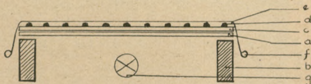
Ryc. 2. Stolik zmodyfikowany do kopiowania fotograficznego. a — matówka, b — zewnętrzna obudowa, c — ramka z uwidocznionymi pędami, d — papier fotograficzny, e — podkładka z gąbki, f — płyta, g — żarówka
