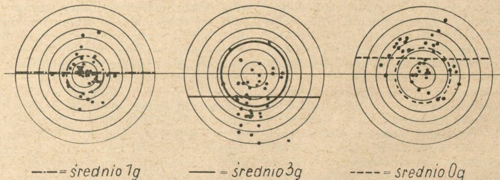
Ryc. 3, 4, 5. Badania koordynacji oko — ręka najpierw na poziomie ziemi (1g) w kabinie samolotu T-33A. Badany stara się uderzyć rylcem środek tarczy, odległej o 1 m. To samo doświadczenie powtarza podczas przyspieszenia 3 g i w okresie nieważkości (0 g) podczas manewrów parabolicznych. Powyższe wyniki wykazują skłonność do uderzenia za nisko w czasie wzmocnienia sił grawitacyjnych, a za wysoko podczas stanu nieważkości. Ryc. 3 — średnio 1 g, ryc. 4 — średnio 3 g, ryc. 5 — średnio 0 g
