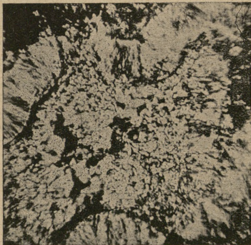
Rys. 1. Chalcedon. Mikrofotografia w świetle spolaryzowanym przy skrzyżowanych nikolach. Powiększenie około 96 ×.
