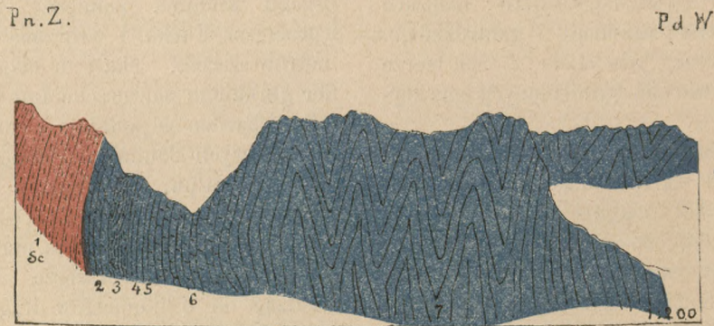
Fig. 3. T. zw. klin jurski w Fernigen (Uri). (1) Łupek serycytowy; (2) brekcyja szkarłupniowa; (3) łupek czarny; (4) oolit żelazny; (5) łupek chlorytowy; (6) wapień tarczowy; (7) wapień alpejski.
