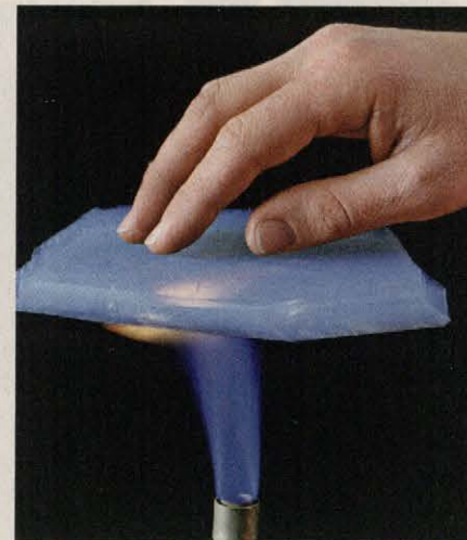
Ten płomień ma temperaturę 1000 st. C. Ten pan nie jest masochistą – chroni go warstwa aerożelu
