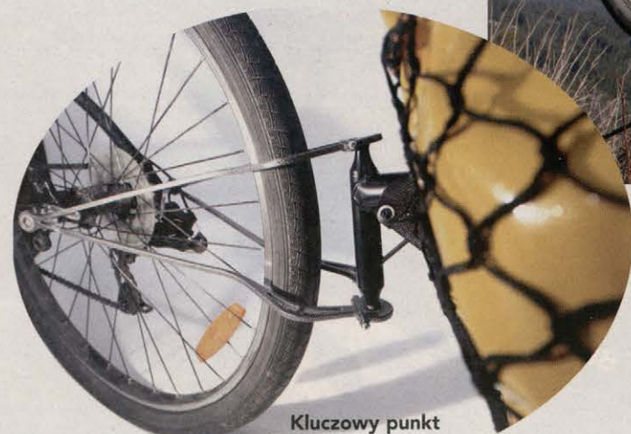
Kluczowy punkt Extrawheela – zaczep łączący przyczepę z rowerem
