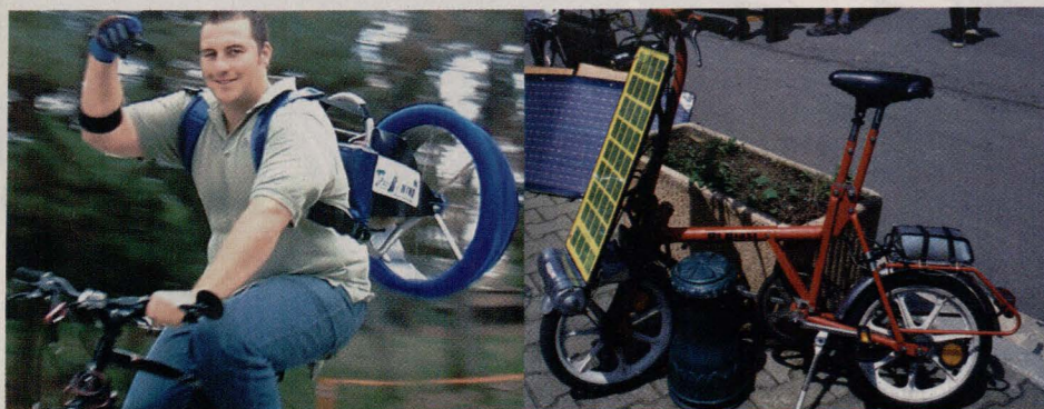
Thrustpac, czyli rozwiązanie dla leniwych. Silnik spalinowy i dwa śmigła pchające rowerzystę
