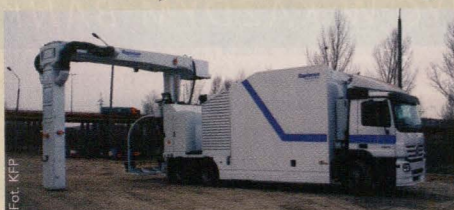
Maszyna prześwietla kontener i analizuje wyniki w zaledwie trzy minuty
