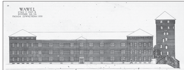
14. Fasady zewnętrzne budynków 9a i 9b, stan z r. 1945, oprac. A. Szyszko-Bohusz. U góry fasada budynku 9b nieodnawiana przez Niemców, niżej fasada budynku 9a po oblicowaniu cegłą i wymianie obramień okiennych przez okupanta
