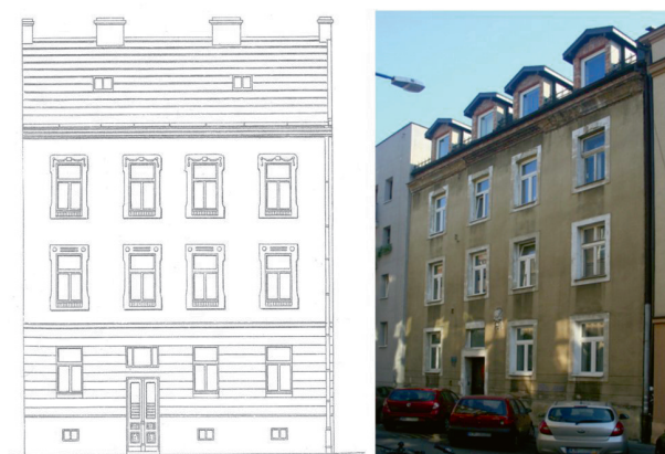
7. Dwupiętrowy dom przy ulicy Konarskiego 7, plan i stan obecny (ABM Konarskiego 7 F403. Plan budowy z dn. 22 VIII 1910). Fot. K. Bańkowska, 2011
