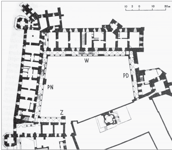
20. Plan parteru zamku na Wawelu z zaznaczonym biegiem schodów Poselskich na I piętro (bez górnego spocznika). Kompilacja planów wg Katalogu Zabytków , sporządził M. Fabiański
