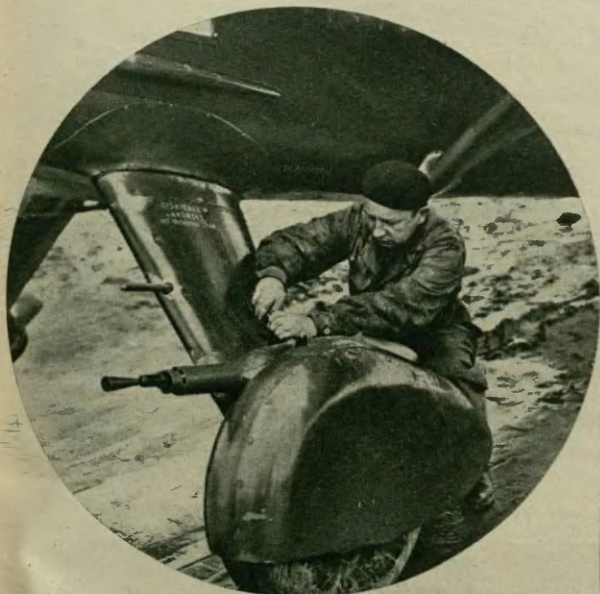
Karabin maszynowy wmontowany w gołęń podwozia samolotu pocigowo-bombowego.
