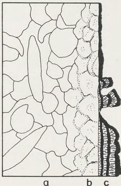
21. Schematyczny przekrój przez zewnętrzną sferę wietrzejącego wapienia pińczowskiego: a — wapienie niezwierteżone, zwarte, b — wapienie zwietrzalone, o rozluźnionej strukturze, c — powierzchniowa kora zwietrzelinowa, składająca się z gipsu, reaktorów wapiennych i zabrudzeń
